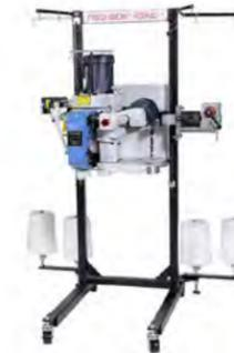
Esta innovadora máquina cierra bolsas de diverso tipo, incluidas las de papel multicapa, tejidas, de polipropileno tejido laminado y yute. Su diseño único, utiliza un cabezal de costura de dos agujas modelo 100-2, incluye un sistema de alimentación de bolsas y un pedestal compacto con ruedas que minimiza la vibración y hace que el sistema sea fácil de mover. Dado que se puede ajustar la altura de costura en sólo segundos, el cambio de bolsas es una tarea ágil y sencilla.
