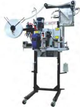
El modelo 400T HP incorpora el cabezal cosedor modelo 201 de la serie Empress® con su consagrado diseño autolubricante. De magnífica ingeniería y pensado para satisfacer los más exigentes requerimientos de embolsado, el sistema 400T HP incluye un rango completo de componentes y accesorios, tales como nuestro sistema de mando directo de velocidad ajustable y bobina de cinta eléctrica.
