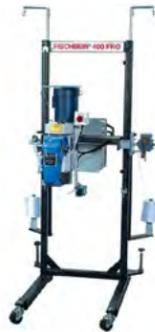
Dos veces mas rápida que cualquier cosedora de bolsa portátil, la 400 PRO opera a velocidades de hasta 60 pies lineales por minuto y es ideal para cerrar una gran variedad de bolsas de papel multi-capas y de polipropileno. Además, la 400 PRO se puede usar manualmente, semi-manualmente o en forma totalmente automática en su operación de cerrado de sacos.
