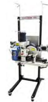
Este innovador sistema de costura puede cerrar gran variedad de bolsas incluyendo las multi-pared, polipropileno tejido y yute. Su pedestal compacto y distintivo, sobre ruedas, minimiza vibraciones y facilita el movimiento del sistema. El rápido cambio de altura del plano de costura, facilita enormemente el cambio de tamaño de bolsas.
